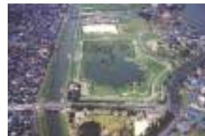
大吉調節池は、新方川流域の浸水被害を軽減するために整備された施設で、40万tの洪水調節容量があります。平常時は、人と自然がふれあえる空間となるよう、水辺の生態系を復元した親水公園となっています。また、堤防上に整備された1周1.2kmのジョギングコースは、健康増進の場として多くの市民に利用されています。
